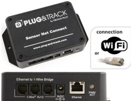
Das **Sensor Net Connect** ist ein intelligenter Hub, der sich direkt mit dem Netzwerk verbindet, an einen können bis zu drei Temperatur- oder Feuchtigkeitsensoren angeschlossen werden. Der Hub kommuniziert mit den Sensoren mit der gewählten Frequenz. Die Daten werden direkt zur Software Thermoscan IP geschickt und archiviert. Bei Überschreitung eingestellter Grenzwerte werden Sie per E-Mail oder Pop Up alarmiert.
